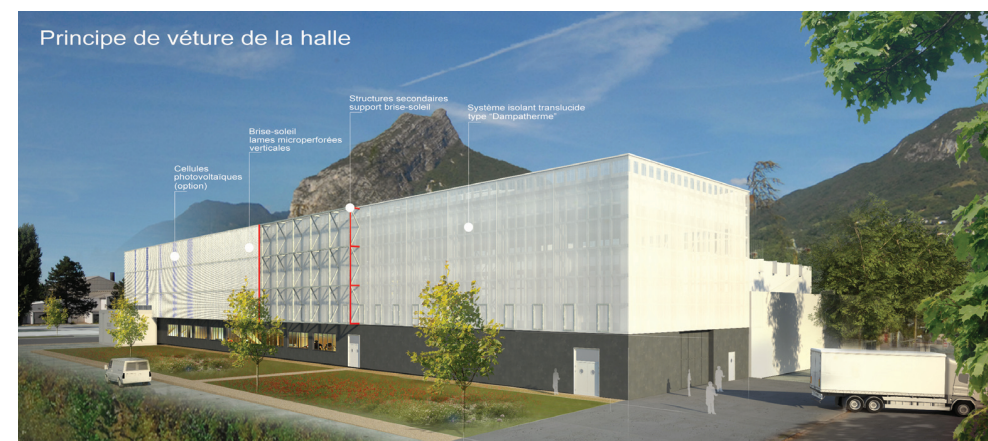
Principe de vêtue de la halle
